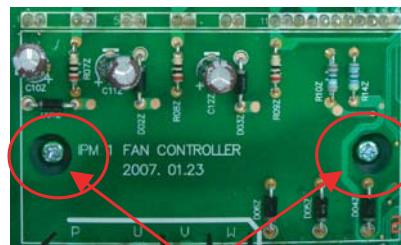
Fan IPM assemble position
